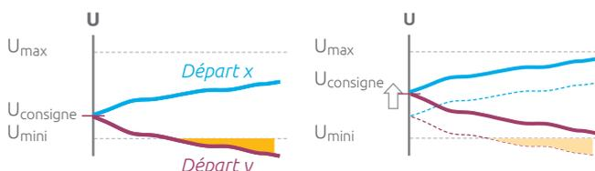
Le réglage de la tension de consigne se fait de façon dynamique quand les valeurs de tension estimées sur le réseau sont en dehors des plages de tension admissibles : en cas de forte production HTA et/ou BT et de faible consommation, les contraintes de tension haute sont résolues par la baisse de la tension de consigne ; en cas de faible production et de forte consommation, les contraintes de tension basse sont résolues par la hausse de la tension de consigne.
